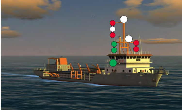
1.3.8.J. — Drague en route avec obstruction à bâbord (Règles 27 d-i et 27 d-ii).
