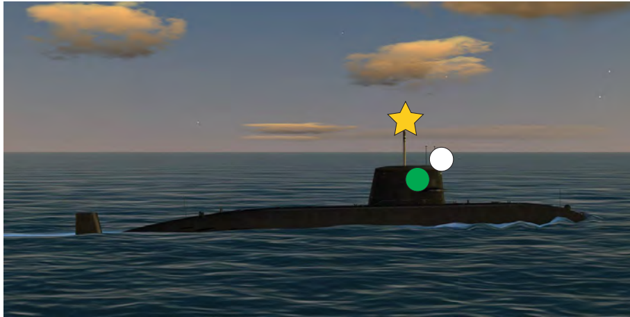
1.3.4.H. — Sous-marin faisant route vers la droite de l'observateur.
