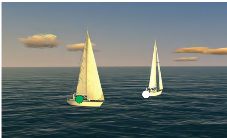
1.3.6.A. — Navires à voile montrant un feu de côté (tribord) et un feu de poupe.
