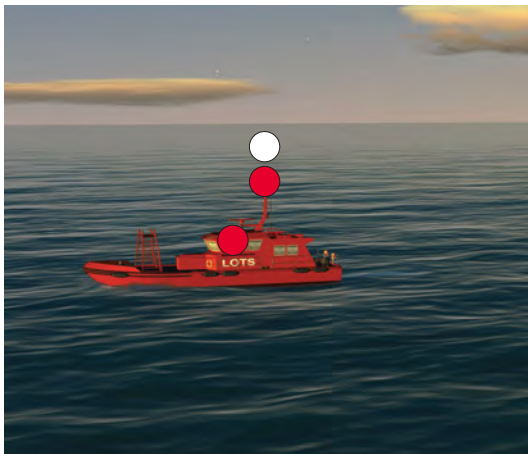
1.3.10. — Bateau-pilote en route (à gauche) et au mouillage (à droite) [Règle 29].
