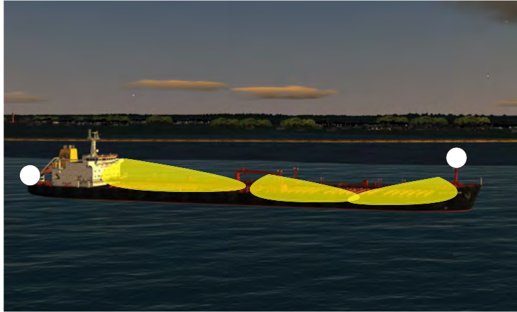
1.3.11.C. — Navire au mouillage utilisant ses feux de travail (obligatoire pour les navires de longueur supérieure ou égale à 100 m) [Règles 30 a-i, 30 a-ii et 30 c].
