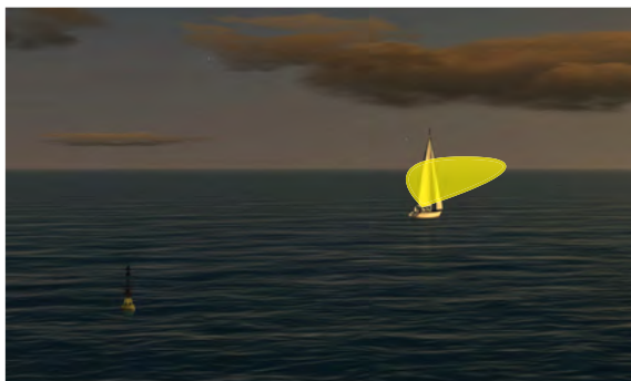
1.3.6.D. — Fanal blanc montré pour prévenir une collision par un navire à voile de moins de 7 m de long (Règle 25 d-i) et un navire à l'aviron (Règle 25 d-ii).
