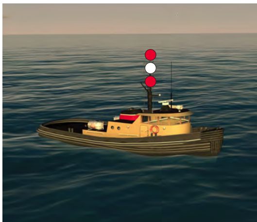
1.3.8.N. — Navires participant à des opérations de plongée (Règles 27 e-i et 27 e-ii).
