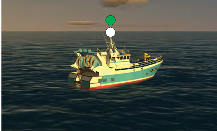
1.3.7.A. — Chalutier sans erre de longueur inférieure à 50 m - Les feux vert et blanc sur le mât sont visibles sur tout l'horizon (Règle 26 b-i).
