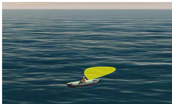
1.3.6.D. — Fanal blanc montré pour prévenir une collision par un navire à voile de moins de 7 m de long (Règle 25 d-i) et un navire à l'aviron (Règle 25 d-ii).
