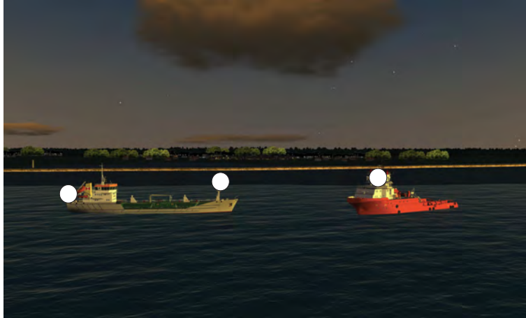
1.3.11.A. — Navire au mouillage de longueur supérieure ou égale à 50 m et inférieure à 100 m (à gauche) [Règles 30 a-i et 30 a-ii] - Navire au mouillage de longueur inférieure à 50 m (à droite) [Règles 30 a-i et 30 b].
