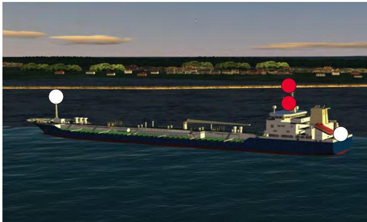
1.3.11.D. — Navire échoué (Règles 30 a, 30 b et 30 d-i).
