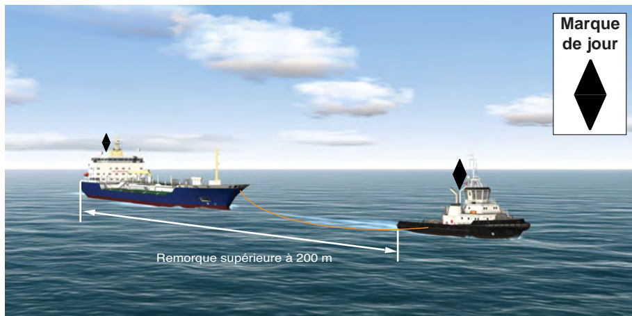
1.3.5.D. — Remorqueur remorquant avec une longueur de remorque supérieure à 200 m. La marque de jour n'est pas hissée si la longueur de la remorque est inférieure ou égale à 200 m (Règles 24 a-v et 24 e-iii).
